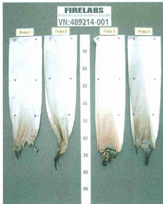
Bild 2 Aussehen des Probekörpers nach dem Brandversuch
