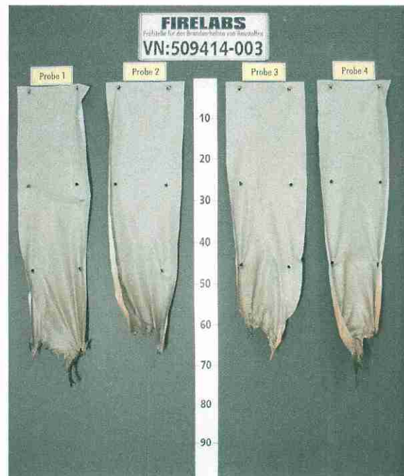
Bild 14 Aussehen der Probekörper nach dem Brandversuch
