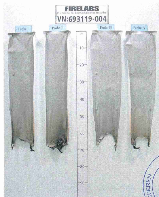
Bild 8 Aussehen des Probekörpers nach dem Brandversuch
